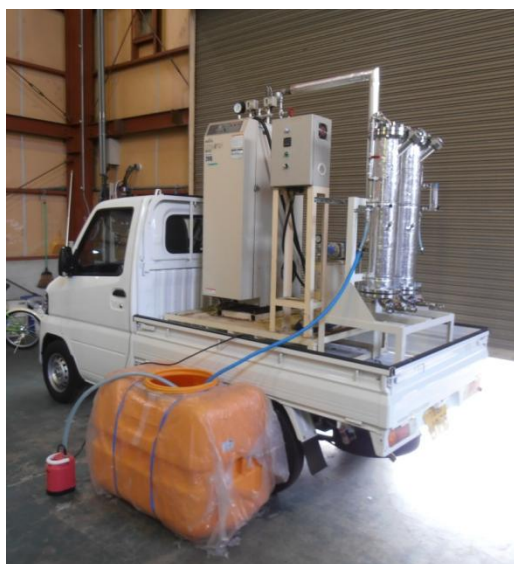
【移動式小型造水装置】(処理量:5m 3 /日)
