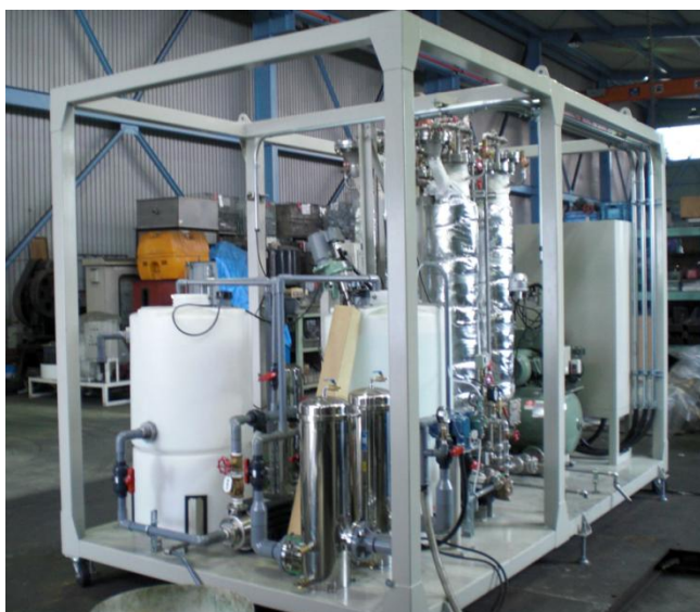
【排水浄化処理装置(中型)】(処理量:10t/日)
