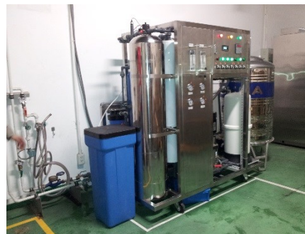
除鉄+RO膜ろ過装置 400L/h 環境試験用(日系ベトナム工場)
